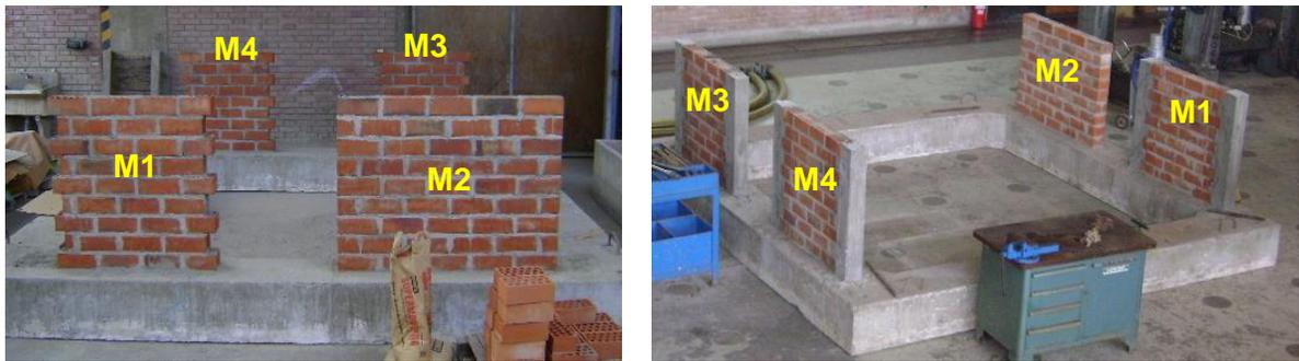
Fig.2. Parapetos analizados. Primero se construyó la albañilería sobre un anillo de concreto.
