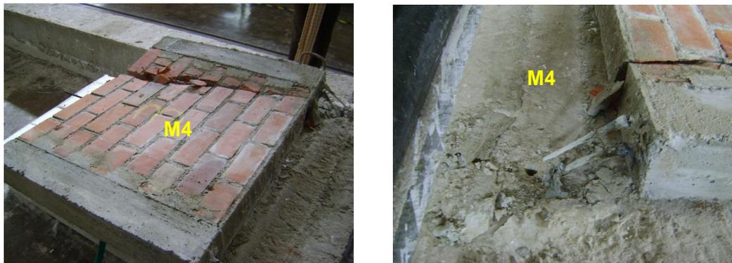
Fig.13. Parapeto M4-Fase 3. Falla por anclaje del refuerzo vertical.
