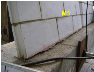
Fig.14. Ensayo estático, D = 50mm. Falla final por anclaje del refuerzo vertical en muretes M1 (anclaje 12cm) y M2 (anclaje 5cm).
