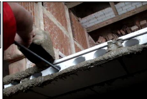
Fig.4. Murete M2. Sección, relleno del epóxico con el dedo, cintas de grout en refuerzo horizontal, taponado con papel en alveolos libres, la albañilería fue parcialmente rellena.
