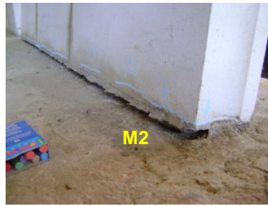
Fig.14. Ensayo estático, D = 50mm. Falla final por anclaje del refuerzo vertical en muretes M1 (anclaje 12cm) y M2 (anclaje 5cm).
