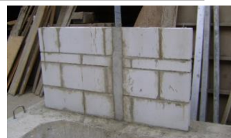
Fig.5. Murete M3 con tubo PVC de 2". Secciones horizontales y vertical. El espacio entre el tubo y los bloques se rellenó con grout.
