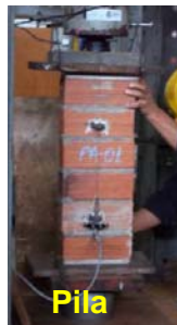
Fig.3 Pilas y muretes. En las pilas Se usó 2 LVDT para medir el módulo de elasticidad “Em”.
