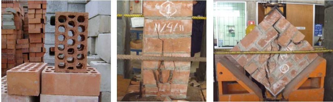
Fig.3. Ladrillo hueco (izq.), y formas de falla de la pila (centro) y del murete (der.)
