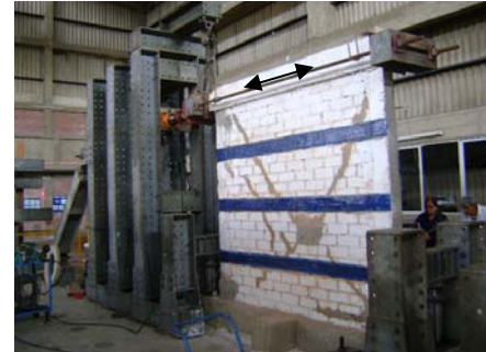
Fig.9 Ensayo del muro rehabilitado.
