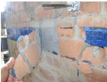
Fig.14. Fase 11 (D1 = 25mm), deriva 0.01. Ruptura y despegue de las bandas.
