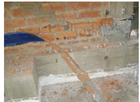
Fig.14. Fase 11 (D1 = 25mm), deriva 0.01. Ruptura y despegue de las bandas.
