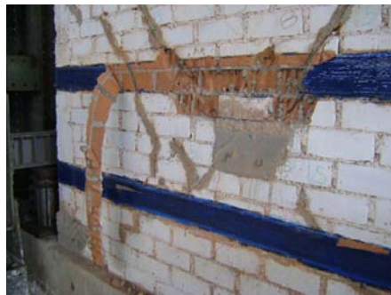
Fig.14. Fase 11 (D1 = 25mm), deriva 0.01. Ruptura y despegue de las bandas.
