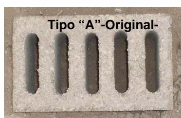
Fig.1 Ladrillos de concreto vibrado.
