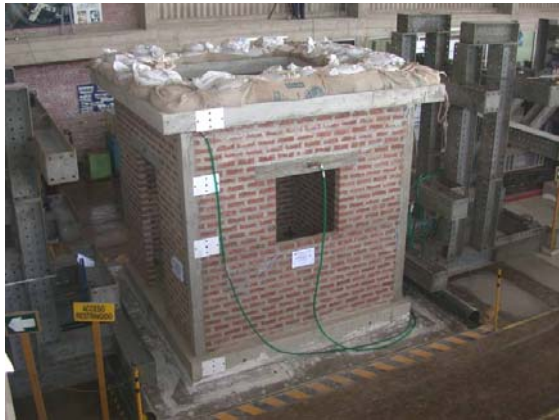
Fig. 6: Módulo A en la mesa vibradora
