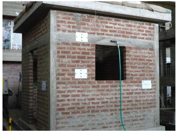
Fig. 7: Módulo B en la mesa vibradora
