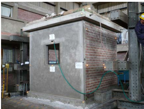
Fig. 8: Módulo C en la mesa vibradora
