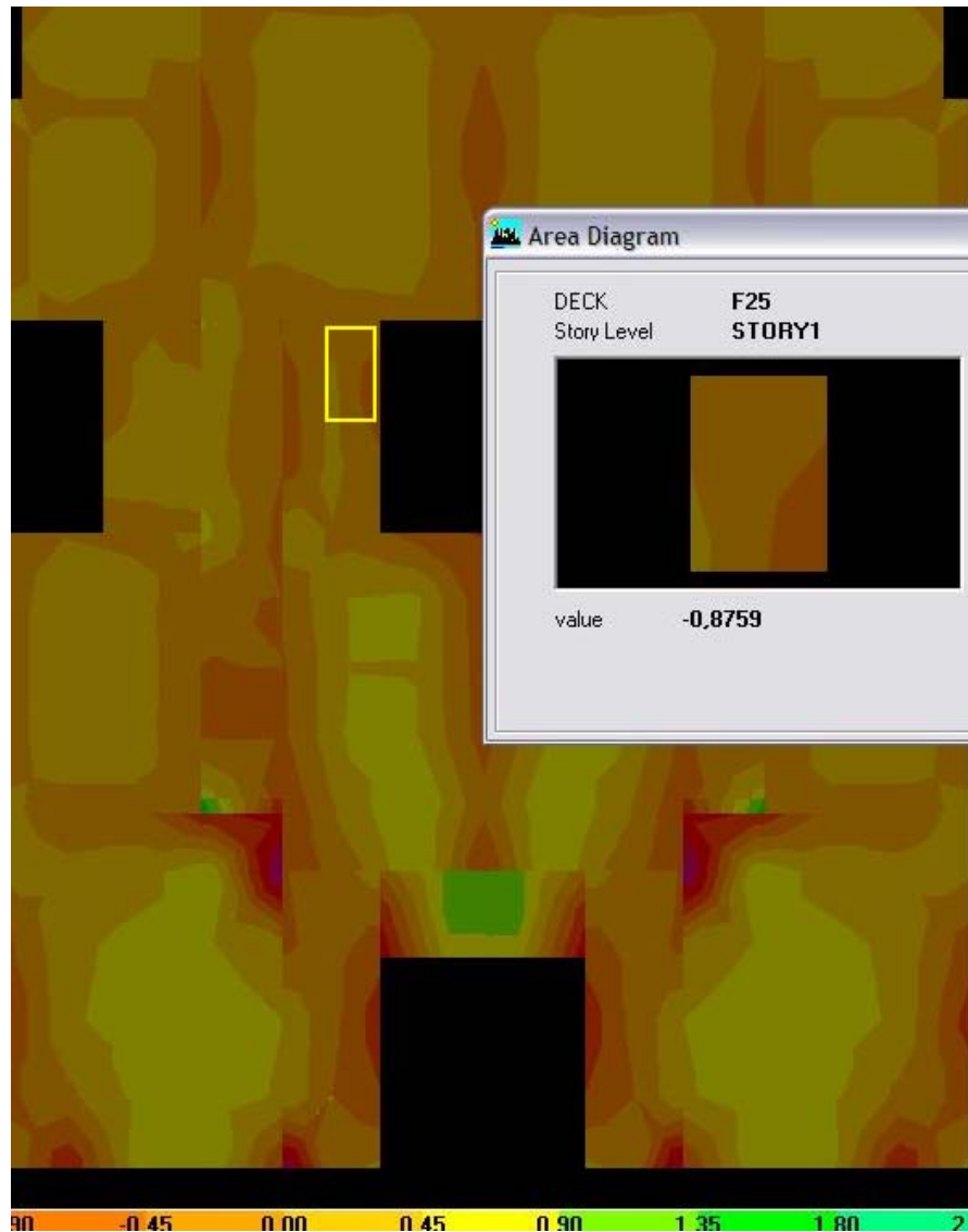
Figura 3.9 Momentos en losa típica de entrepiso
