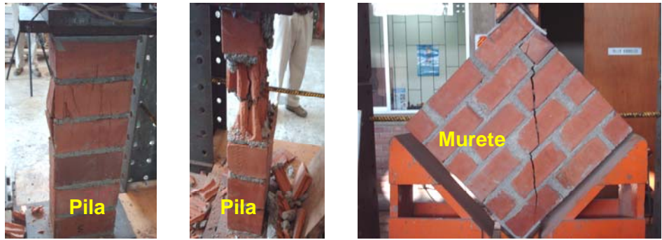
Fig.7 Fallas típicas en los prismas de albañilería simple.
