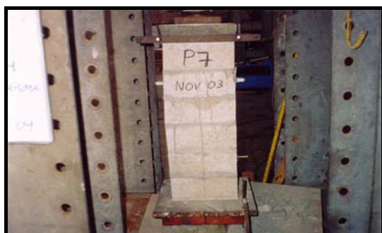
Fig.13. Falla en una pila de la Técnica B.
