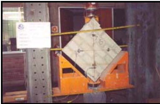
Fig.17. Ensayo de compresión diagonal.
