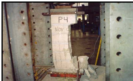
Fig.12. Falla en una pila de la Técnica A.
