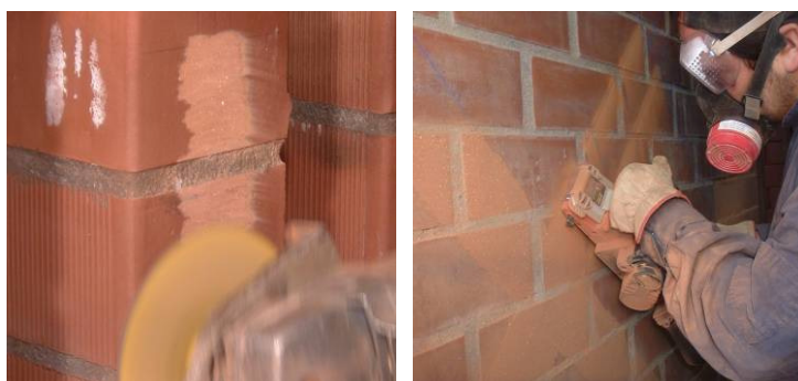
Figura 4 – Tratamiento superficial en probetas de adherencia y en muros.
