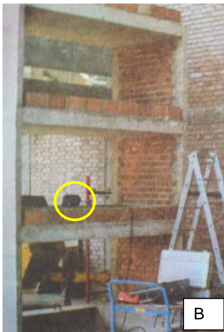
Fig.7. Ensayo de simulación sísmica de un módulo de albañilería confinada en mesa vibradora (C), y ensayos previos al dinámico: A) Ensayo estático aplicando carga lateral en cada nivel independientemente, para determinar experimentalmente la matriz de flexibilidad del espécimen; y, B) Medición del período de vibrar y del grado de amortiguamiento con un sismógrafo.
