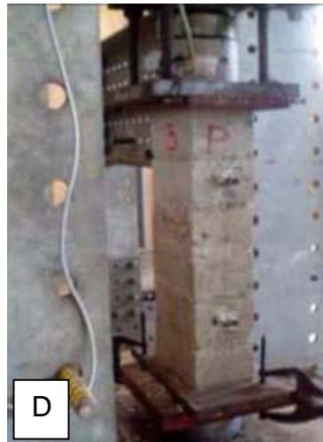
Fig.2. Ensayos de control: A) Compresión en una probeta de concreto, el LVDT mide la deformación axial con lo que se calcula el módulo de elasticidad " E_c "; B) Tracción del refuerzo y su gráfica carga-desplazamiento; C) Adherencia acero-albañilería, para determinar la longitud de anclaje de chicotes o mechas de anclaje en la conexión columna-albañilería; D) Compresión Axial sobre una pila de albañilería instrumentada con LVDT para evaluar el módulo de elasticidad " E_m ", la resistencia a compresión de una pila ( f_m ) se calcula dividiendo la carga máxima entre el área bruta de la sección transversal, la resistencia característica ( f'_m ) se obtiene restando una desviación estándar al valor promedio de " f_m "; y, E) Compresión diagonal de muretes.
