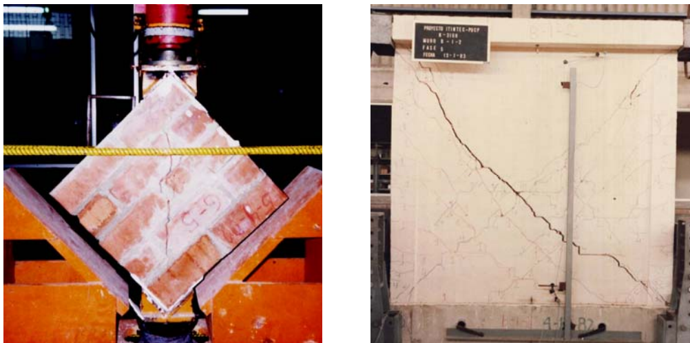
Fig.5.7. Falla por tracción diagonal en murete (izquierda) y en muro (derecha).
