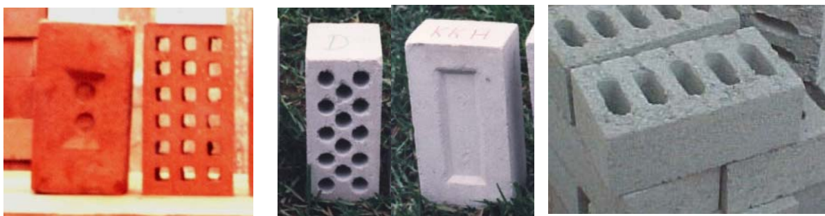
Fig.2.28. Ladrillos de arcilla (izquierda), sílice-cal (centro) y de concreto (derecha).
