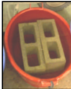
Fig.1 Ensayos de absorción (izq.) y de alabeo (der.) de los bloques.
