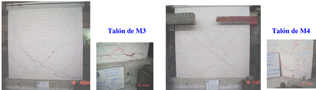
Fig.13. Estado de M3 (izq.) y de M4 (der.) y de sus talones al aplicar D1 = +20\text{mm} en la fase 10 del ensayo.
