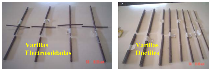
Fig.20 Formas de falla de las varillas dúctiles y electrosoldadas.
