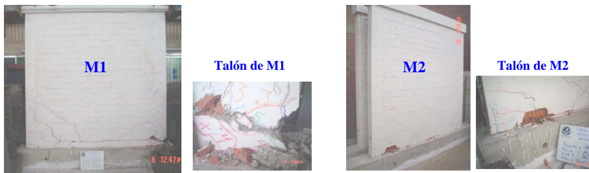
Fig.11. Estado de M1 (izq.) y M2 (der.) y de sus talones, después de la fase 9 del ensayo.
