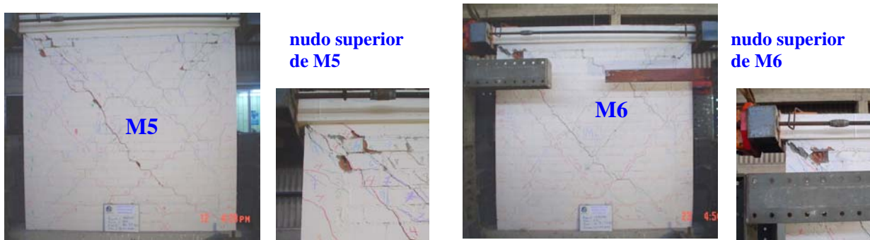
Fig.14. Estado de M5 (izq.) y M6 (der.) y de sus nudos superiores al aplicar D1 = +20\text{mm} en la fase 10 del ensayo.
