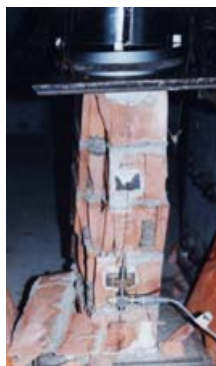
Figura 2. Falla frágil a compresión axial en un prisma hecho con ladrillos con 40% de huecos
