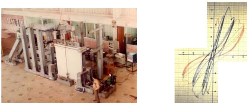
Figura 6. Ensayo de carga lateral cíclica de muro confinado con carga axial constante (izquierda); la degradación de la resistencia lateral se produce por un exceso en la carga axial (derecha)
