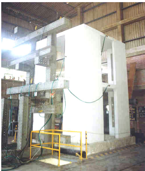
Foto 3 - Ensayo de simulación sísmica
