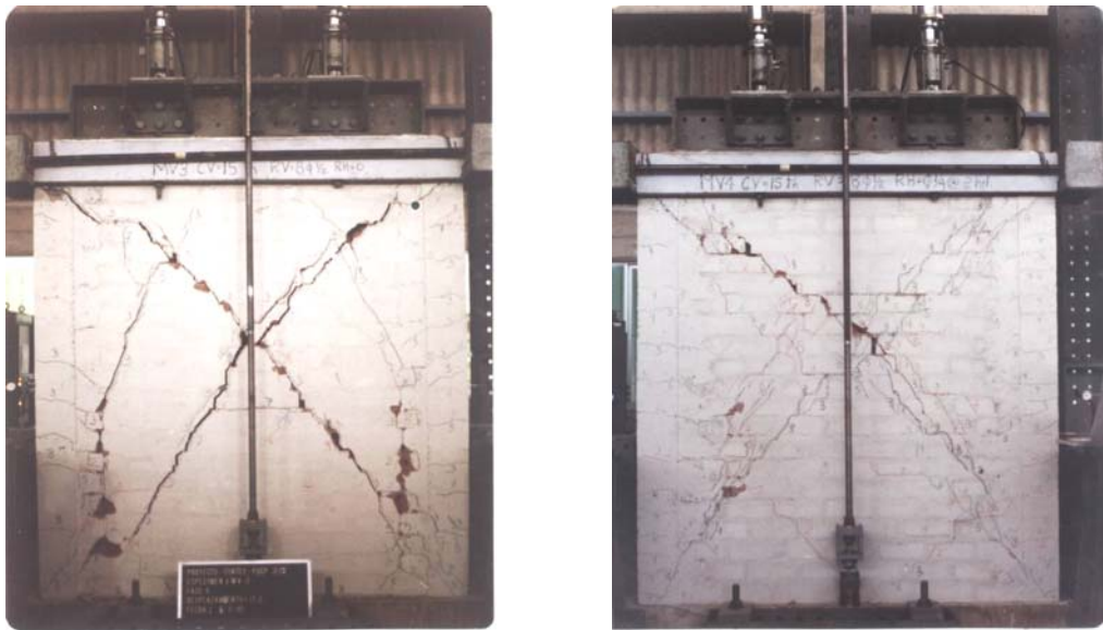
Fig.11. Estado de los muros MV3 (izquierda) y MV4 (derecha), ambos con P = 15\text{ton} y D = +17.5\text{mm} .
