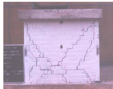
Fig.3. Muro 2. Ensayo estático. Fase final. Distorsión 0.001
