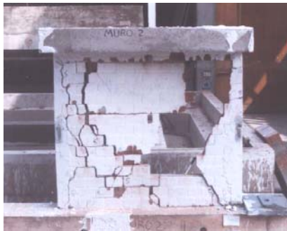
Fig.6. Muro 2 después del ensayo dinámico.
