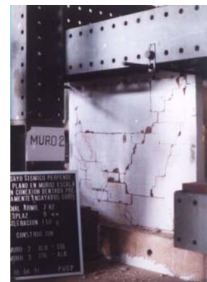
Fig.3. Muro 2. Ensayo estático. Fase final. Distorsión 0.001
