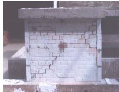
Fig.7. Muro 3 después del ensayo dinámico.
