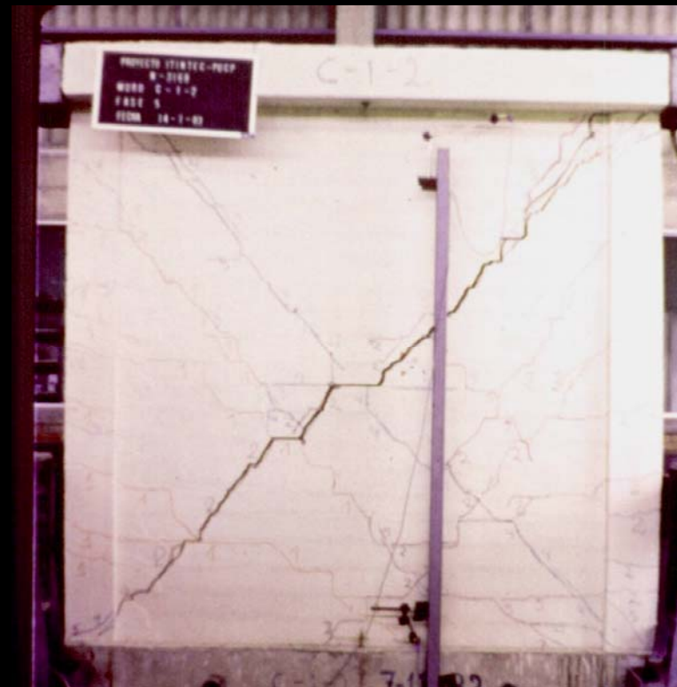
Ladrillos con 30% de huecos (unidades sólidas)
