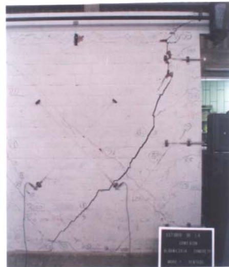
Fig.3. Ensayo de adherencia del chicote.
