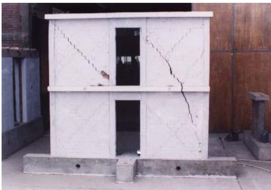
Fig.8. Caso “Viga Peralzada” – Fase 5. Obsérvese la Falla por tracción en la solera del muro B.
