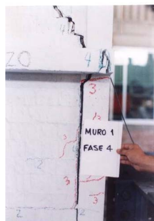
Fig.7. Detalle de la falla por anclaje del refuerzo de la solera. Caso “Voladizo”.
