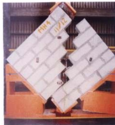
Fig.3. Falla Escalonada en un Murete.
