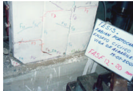
Foto 12. Patrón de fallas en la viga de albañilería.
