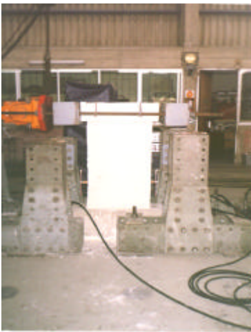
Foto 11. Dispositivos para el ensayo de carga lateral.
