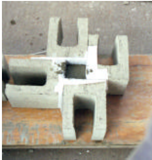
Foto 1. Moldeado del Grout
