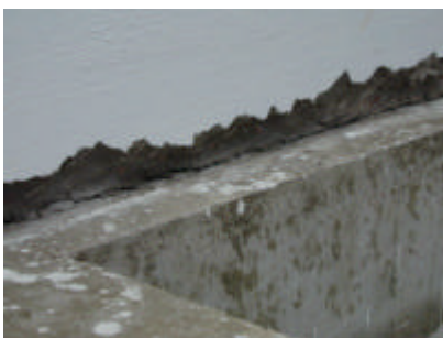
Fig.9. Observaciones post-ensayo del muro reparado (para una mejor visualización se removió una parte del tarrajeo). Deslizamiento en la base (izq.) y pandeo del refuerzo vertical (der.).
