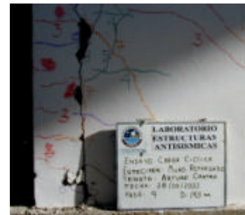
Fig.8. Muro reparado después de la fase 9 (izq.) y grieta vertical en la unión columna-albañilería (der.).
