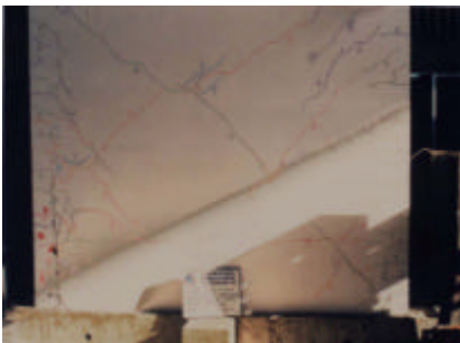
Fig.8. Muro reparado después de la fase 9 (izq.) y grieta vertical en la unión columna-albañilería (der.).
