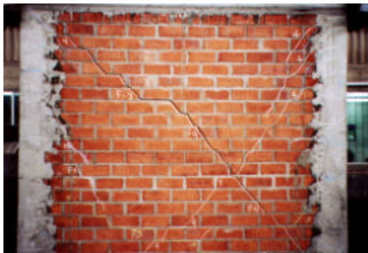
Fig.4. Falla por corte (izq.) y trituración de algunos ladrillos (der.).
