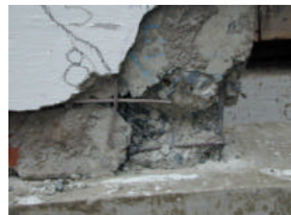
Fig.9. Observaciones post-ensayo del muro reparado (para una mejor visualización se removió una parte del tarrajeo). Deslizamiento en la base (izq.) y pandeo del refuerzo vertical (der.).
