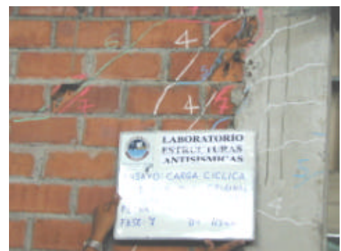
Fig.4. Falla por corte (izq.) y trituración de algunos ladrillos (der.).
