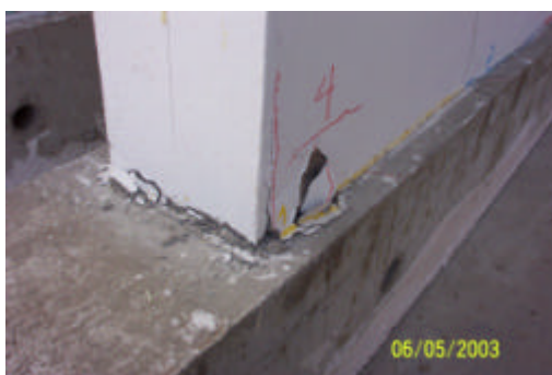
Fig.14. Estado del talón al término del ensayo (izquierda) y desmoronamiento del talón al retirar la malla de confinamiento en forma de U (derecha).
