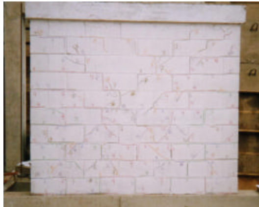
Fig.4 Estado del muro original al finalizar el ensayo. Se apreció una falla predominante por corte.
