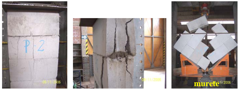
Fig.3 Formas de falla de las Pilas y Muretes.
