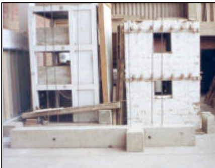
Foto 1. Refuerzo Vertical anclado en la viga de cimentación
