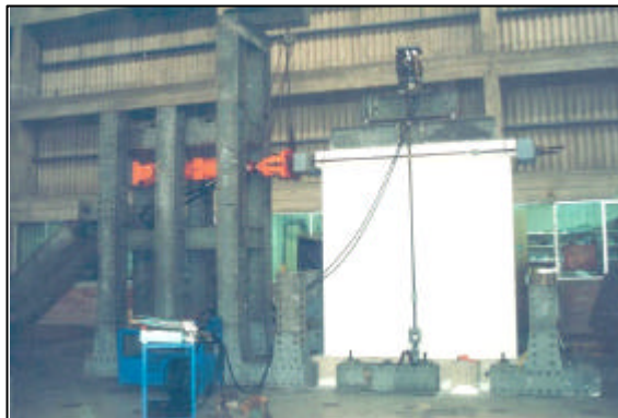
Foto 9. Dispositivo de ensayo para muros sujetos a carga vertical.
