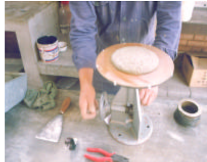
Fig.6. Mesa de sacudidas para medir la fluidez del mortero
