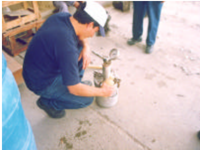
Fig.5. Equipo neumático para medir el contenido de aire del mortero.
