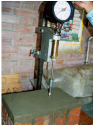
Fig.7. Penetrómetro de Acme empleado en el ensayo de penetración del tarrajeo en pilas.
