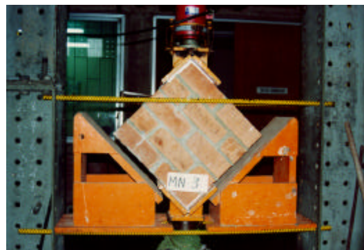
Fig.9. Ensayo de compresión axial en pilas (izq.) y de compresión diagonal en muretes (der.).
