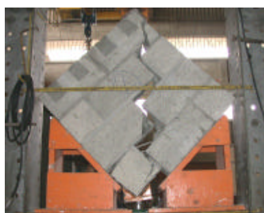
Fig.17. Falla escalonada en muretes rellenos con grout 1: 2 ½ : 1 ½ (cemento tipo I, izquierda) y falla mixta en muretes rellenos con grout 1: 3: 1 (cemento IP, derecha).
