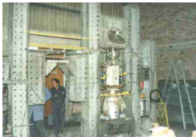
Foto 7. Vista global del ensayo de compresión axial.
