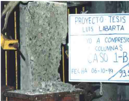
Foto 8. Estado final del espécimen no reforzado (caso 1).
