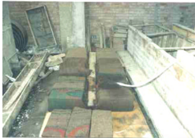
Foto 6. Curado con sacos de yute húmedo sobre los especímenes.
