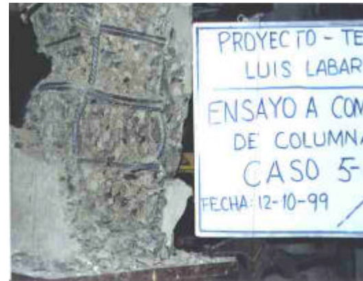
Foto 9. Estado final del espécimen con estribos 1 3/4 vuelta @ 10 cm.
