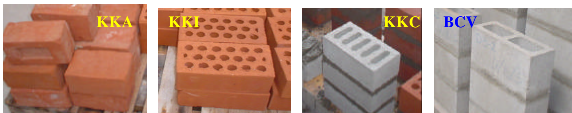
Fig.2. Unidades de albañilería empleadas, de izquierda a derecha: 1) King Kong Artesanal de arcilla (KKA); 2) King Kong Industrial de arcilla (KKI); 3) King Kong industrial de Concreto (KKC); y, 4) Bloque de Concreto Vibrado (BCV).
