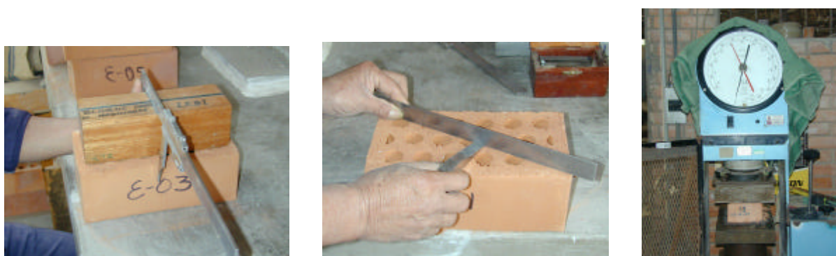
Fig.3. Ensayos de la unidad de albañilería. De izquierda a derecha: Variación de dimensiones, alabeo y compresión.
