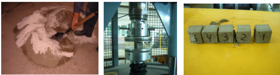
Fig.4. Mortero. De izquierda a derecha: mezcla con cal, ensayo de compresión y probetas ensayadas.
