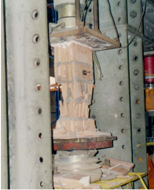
Foto 3. Falla típica de la pila Tipo Patrón y con Cemento Pozolánico.
