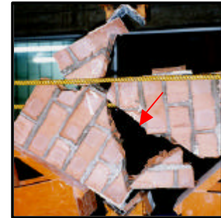
Foto 9 Murete con ladrillo de arcilla. Edad: 28d
