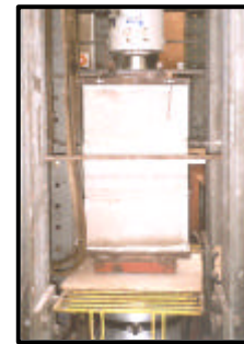
Foto 13 Pilas con bloques de concreto
