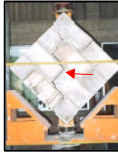
Foto 10 Murete de Bloques de 3 días
