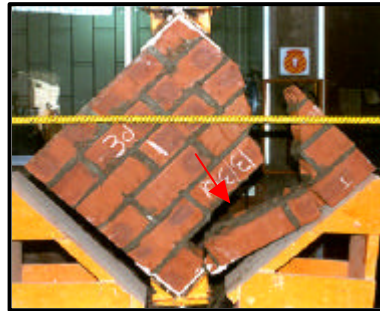
Foto 8 Murete con ladrillo de arcilla. Edad: 3 días
