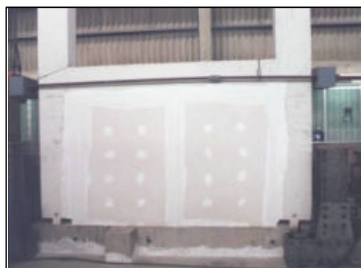
Foto 5. Ensayo Estático con Drywall.
