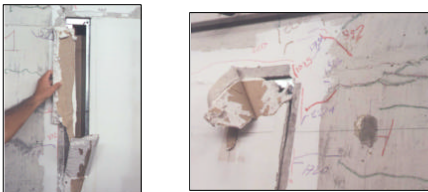
Foto 6. Detalles de la falla por trituracion en las placas en las esquinas del tabique.
