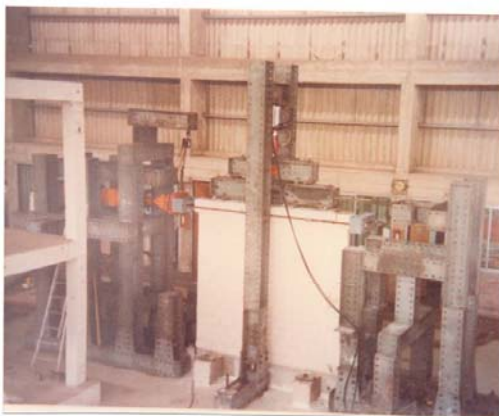
Fig.2. Vista Global de los Dispositivos Mecánicos (izquierda) y Detalle del Dispositivo para Generar la Carga Vertical (derecha).
