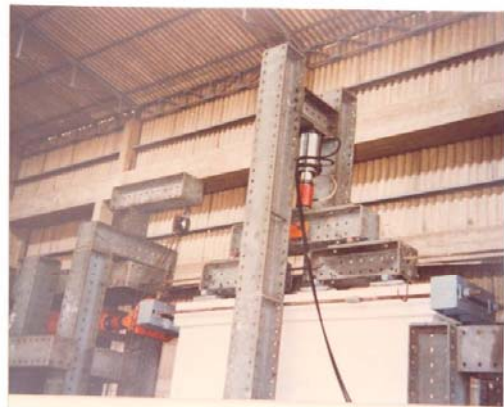
Fig.2. Vista Global de los Dispositivos Mecánicos (izquierda) y Detalle del Dispositivo para Generar la Carga Vertical (derecha).
