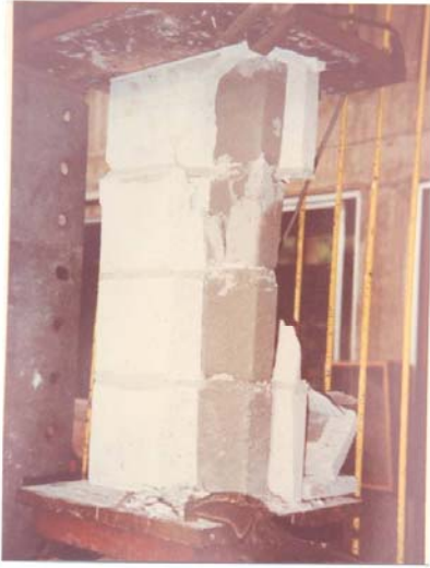
Fig.3. Pila Rellena con Mortero Líquido Sin Planchas.
