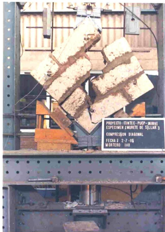
FOTO N° 20 FALLA TIPICA LOGRADA PARA EL MORTERO 1:8 EN EL ENSAYO DE COMPRESION DIAGONAL
