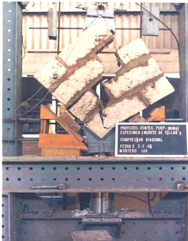
FOTO N° 20 FALLA TIPICA LOGRADA PARA EL MORTERO 1:8 EN EL ENSAYO DE COMPRESION DIAGONAL
