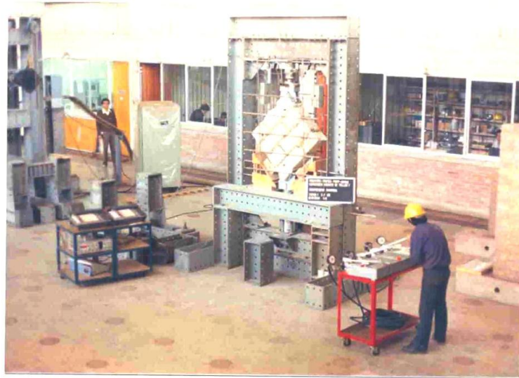
FOTO N°19 ENSAYO DE COMPRESION DIAGONAL Y EQUIPO UTILIZADO
