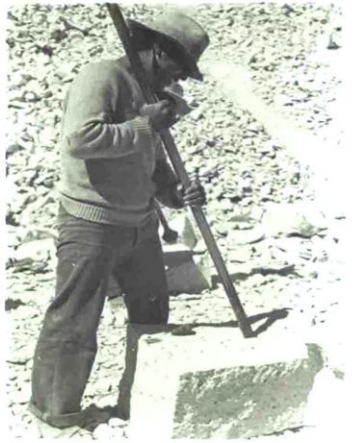
FOTO N° 4 DEB. INICIAL DEL BLOQUE CON BARRETA DE PUNTA PLANA
