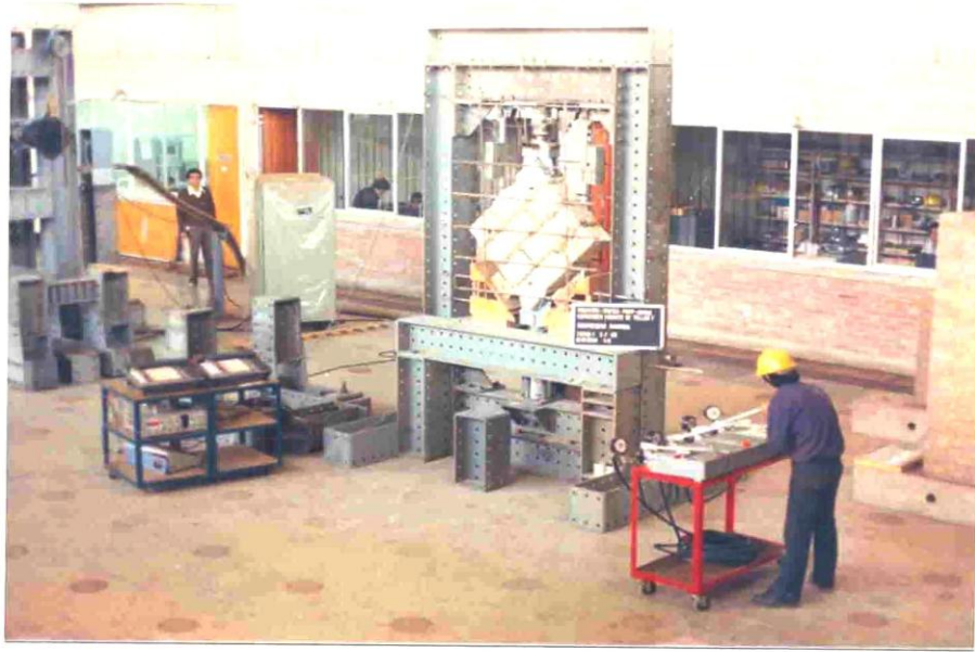
FOTO N° 19 ENSAYO DE COMPRESION DIAGONAL Y EQUIPO UTILIZADO
