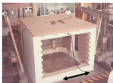
Fig.3. Ensayo sísmico de un módulo de 1 piso [1].
