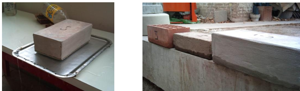
Fig.5 – Prueba de succión en adobe tarrajado (izquierda) y ascenso de agua capilar tras la prueba de succión en los 3 tipos de unidad (derecha).
