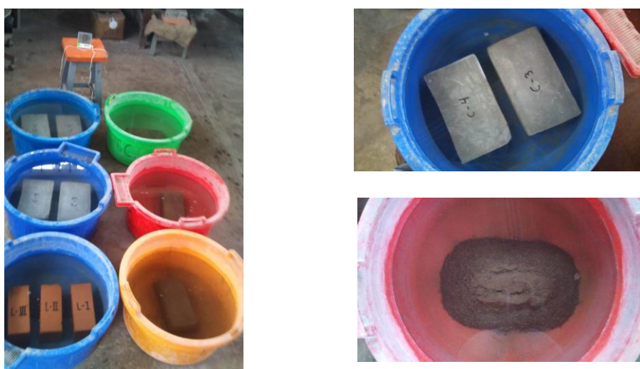
Fig.4 – Prueba de absorción (izquierda) y Absorción a las 24 horas en adobe tarrajado (arriba-derecha) y en adobe tradicional (abajo-derecha).
