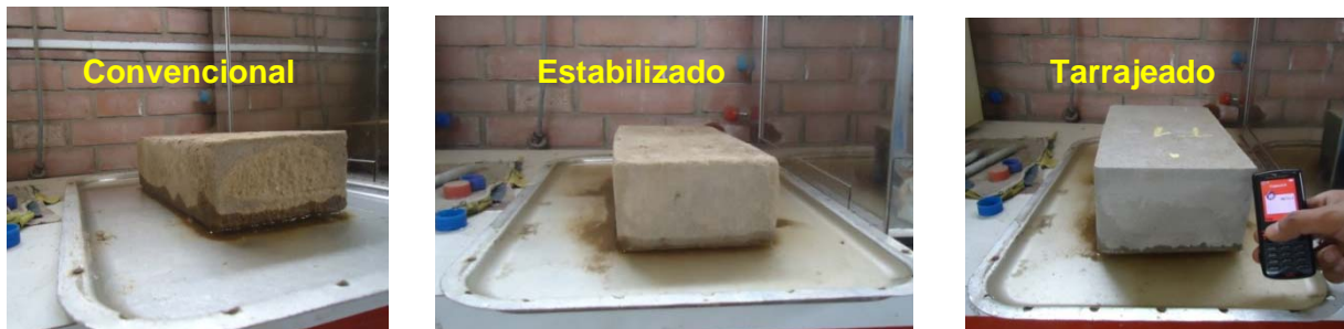
Fig.8. Ascenso capilar en la prueba de succión.
