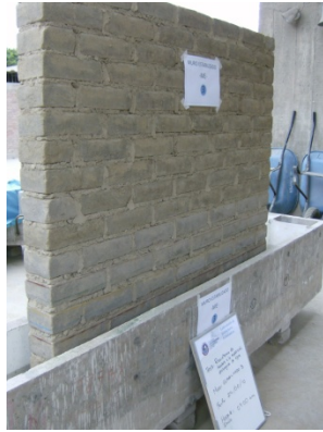
Fig.6 Muro ME. Nótese el color más claro del adobe estabilizado.
