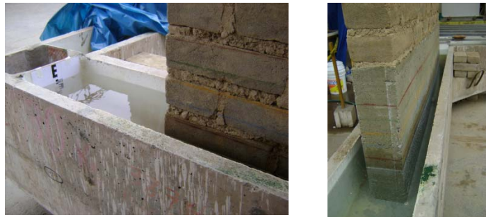
Fig.9 Medición del volumen de agua absorbida (izq.) y del ascenso capilar (der.).
