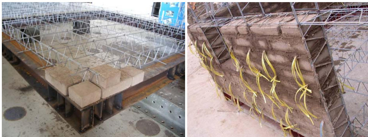
Fig. 4: a) Prueba en seco; b) Hiladas de adobe del cerramiento del prototipo
