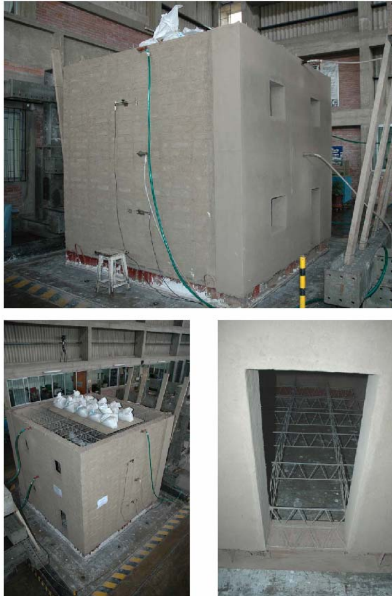
Fig. 5: Vistas del prototipo antes del ensayo de resistencia al sismo: a) Sobre la mesa de ensayos; b) Vista superior; c) Puerta.
