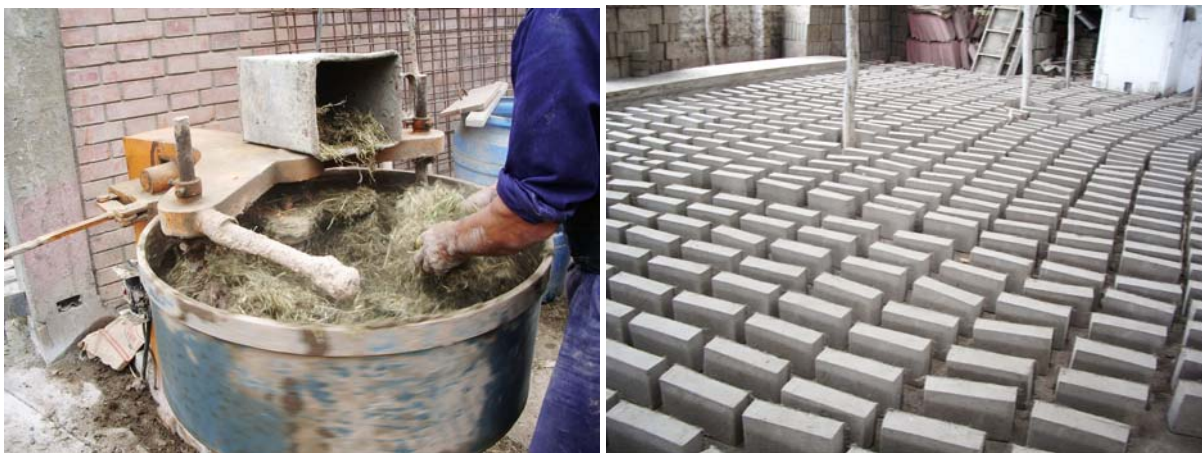
Figure 2: Preparación de adobes: a) Amasado; b) Adobes secados en un patio cubierto
