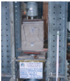
Foto 1. Ensayo de compresión axial en pilas con mortero de barro.
