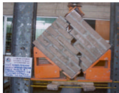
Foto 2. Ensayo de compresión diagonal en muretes con mortero de cemento.
