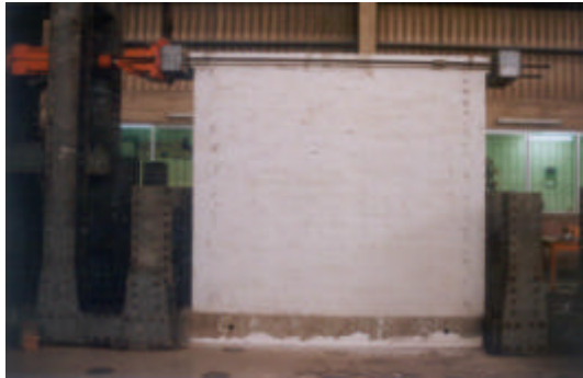
Foto 7. Dispositivos mecánicos para el ensayo de carga lateral cíclica.
