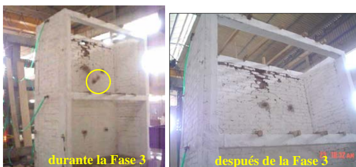
Fig.10. Fase 3. Colapso de un adobe del Piso 2.
