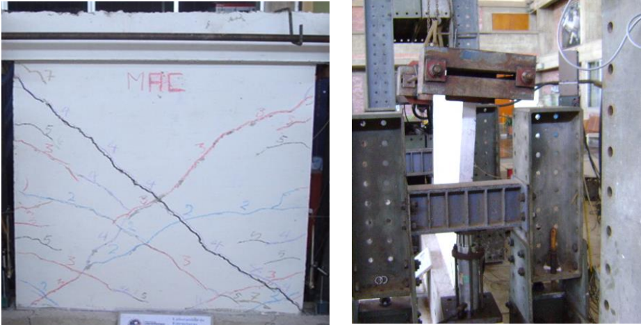
Fig.9. Fase 7 en el muro MAC. Falla final por alabeo.
