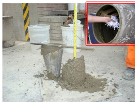
Fig.4. Revenimiento del concreto con fibra de polipropileno (izquierda) y con fibra de acero (derecha).
