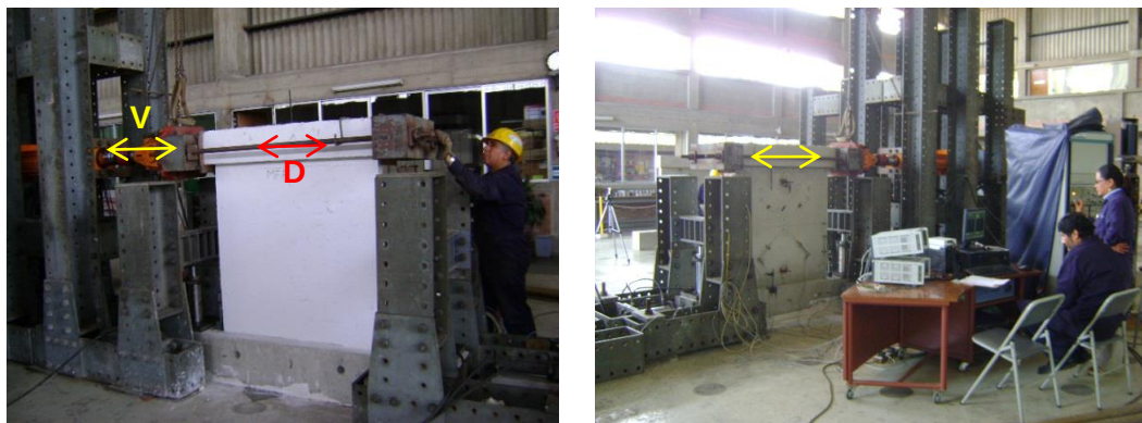
Fig.6. Ensayo de carga lateral cíclica y sistema de adquisición de datos.
