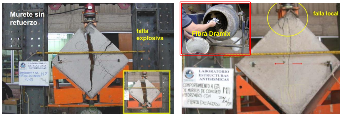
Fig.2 (Ref.1). Murete sin refuerzo (izquierda) y reforzado con fibra metálica (derecha).
