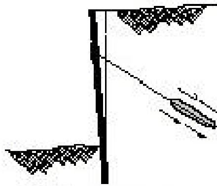
b) Rotura por arranque unión terreno-inyección.
