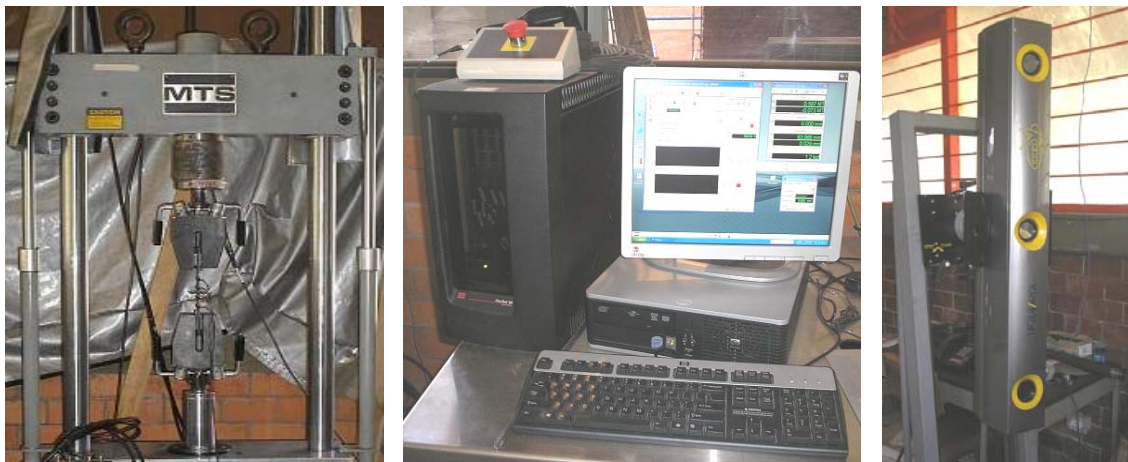
(a) Máquina servohidráulica
