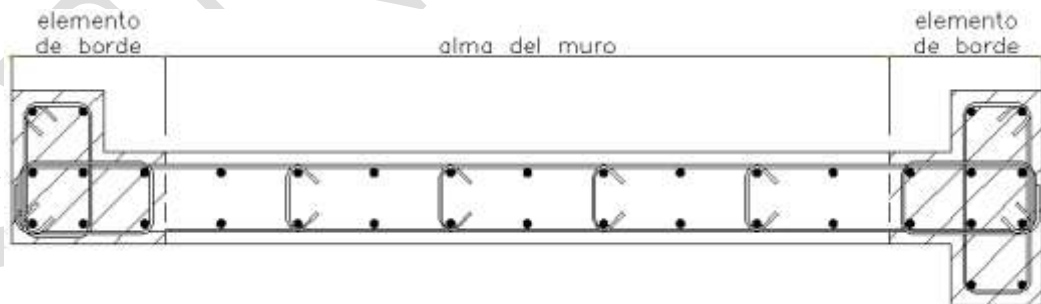
Fig. 21.1b Ejemplo de elementos de borde en muros
