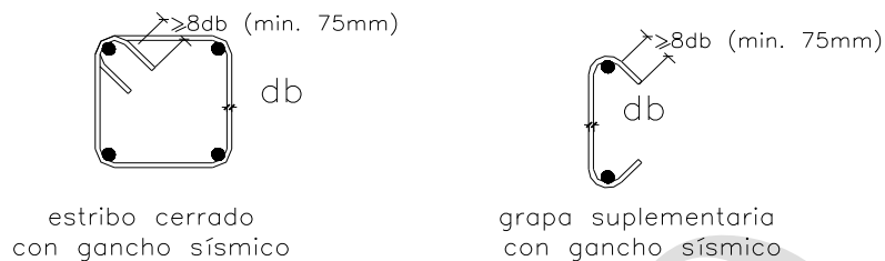
Fig. 21.1d Ganchos sísmicos en estribos y grapas suplementarias
