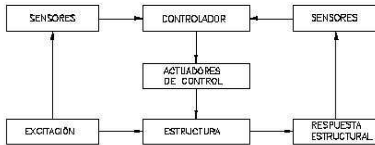
Fig. 1.10 Esquema de funcionamiento de un sistema de control activo
