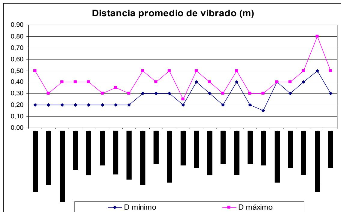
**Gráfico 8.- MONITOREO DE POSICION DE LA MANGUERA DE LA BOMBA DURANTE LA COLOCACION DEL CONCRETO**
